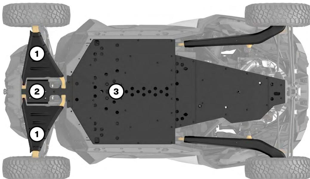
**Nossas placas de plástico deslizam suave e silenciosamente sobre obstáculos, oferecendo excelente proteção em terrenos acidentados. Feito de polietileno termoformado com alto peso molecular (HMWPE) de 10mm (3/8 pol.) de espessura e resistente a abrasão.**
